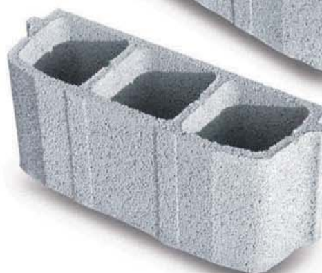
BOVEDILLA CERRADA 70x25x20 - Hormigón: 21,9 Kg - 40 Uds/Palet Arlita: 14 Kg - 40 Uds/Palet BOVEDILLA ABIERTA 70x25x20 - Hormigón: 19 Kg - 40 Uds/Palet Arlita: 13 Kg - 40 Uds/Palet
