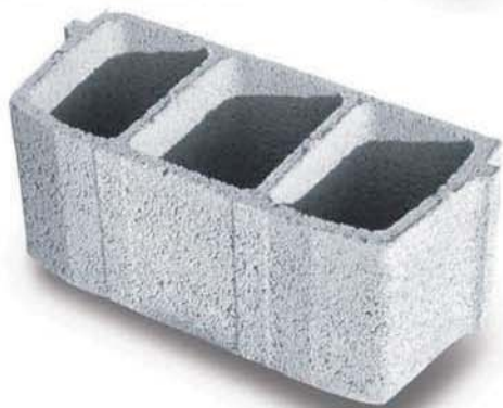
BOVEDILLA 70x25x10 - Hormigón: 14,5 Kg - 80 Uds/Palet Arlita: 9,7 Kg - 80 Uds/Palet
